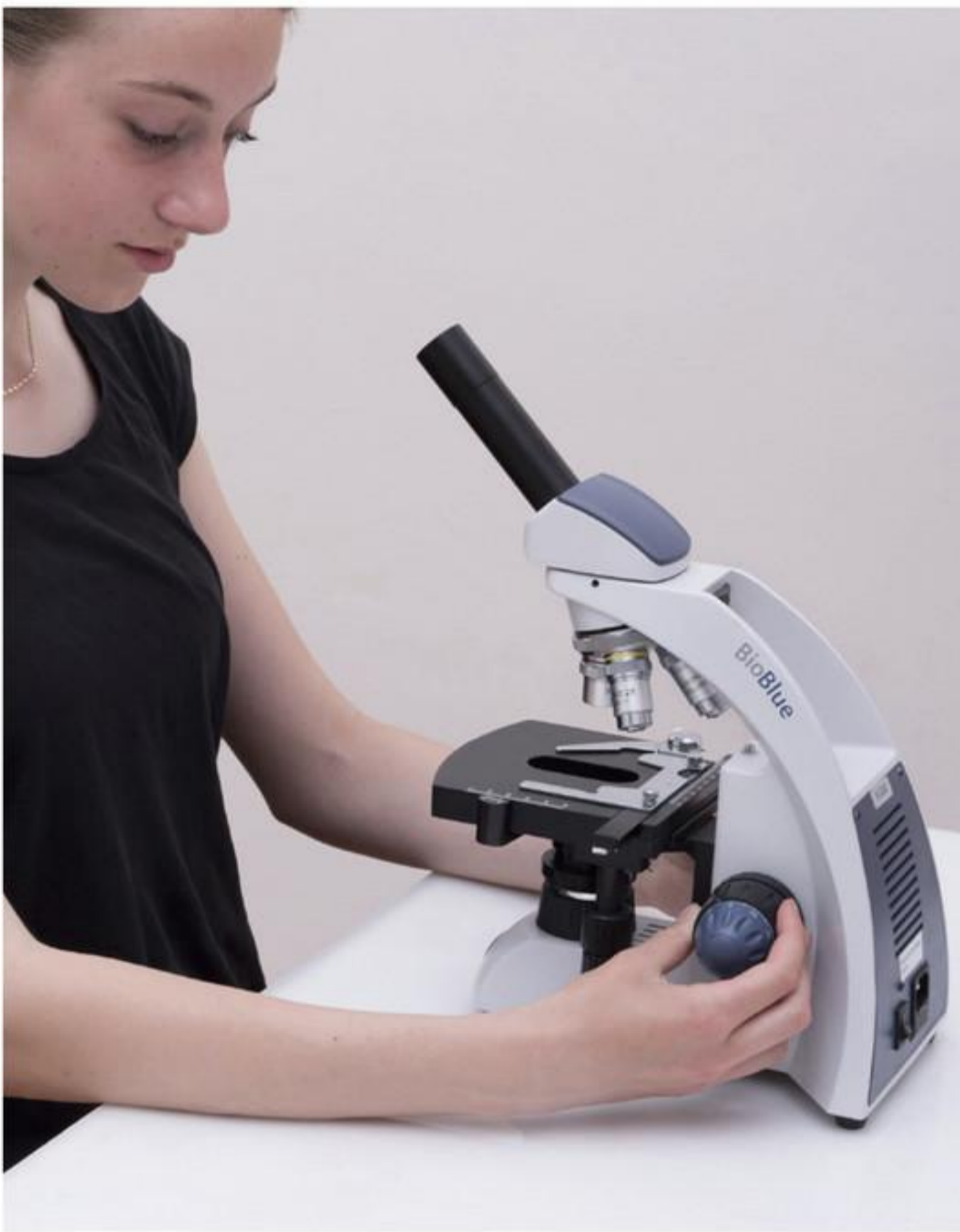
Afb. 6 Scherpstellen bij de kleinste vergroting.
