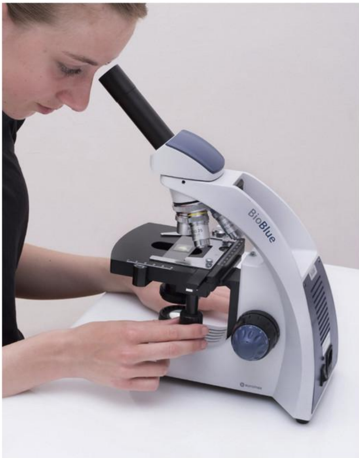
Afb. 7 Scherpstellen bij een grotere vergroting.
