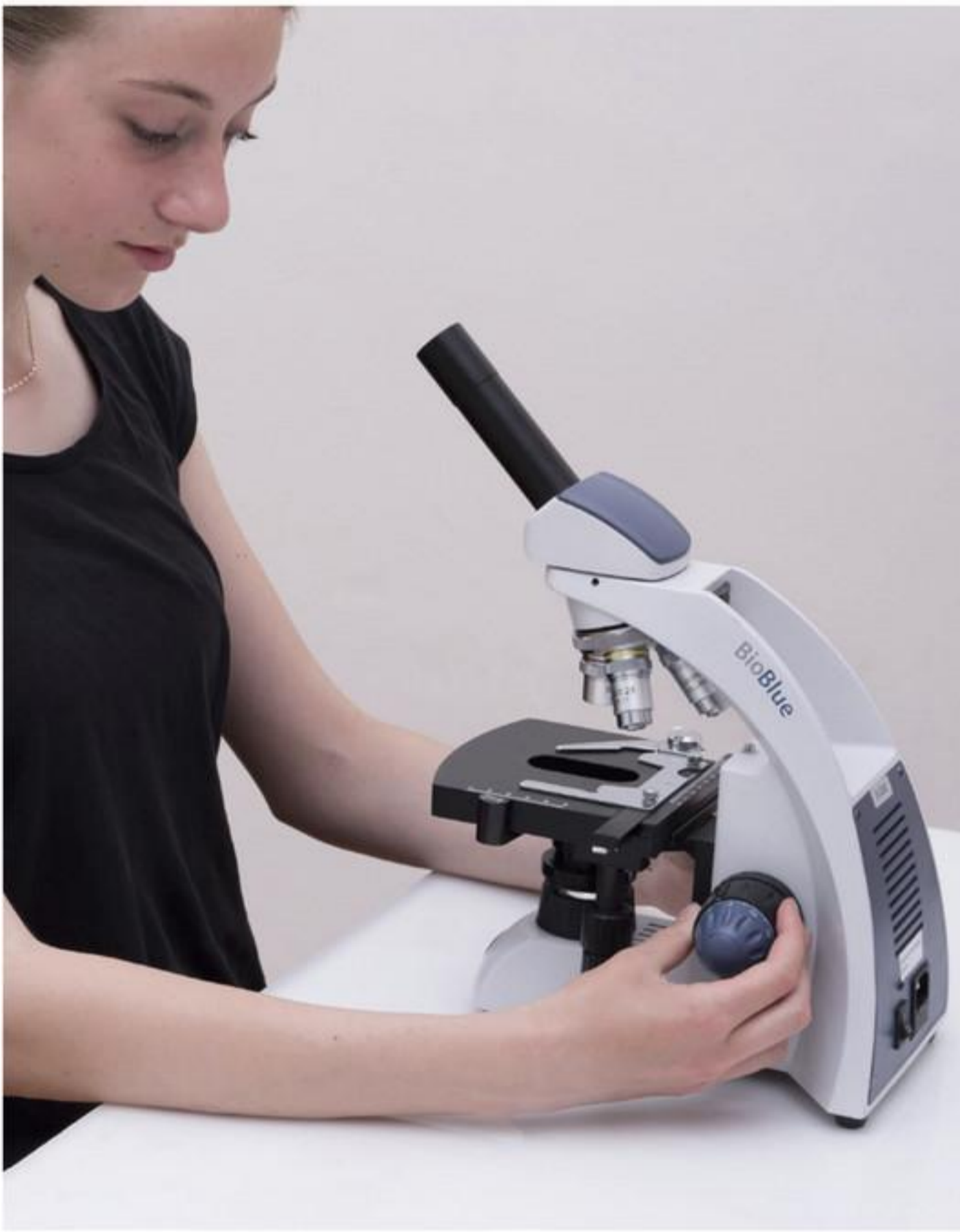
Afb. 6 Scherpstellen bij de kleinste vergroting.
