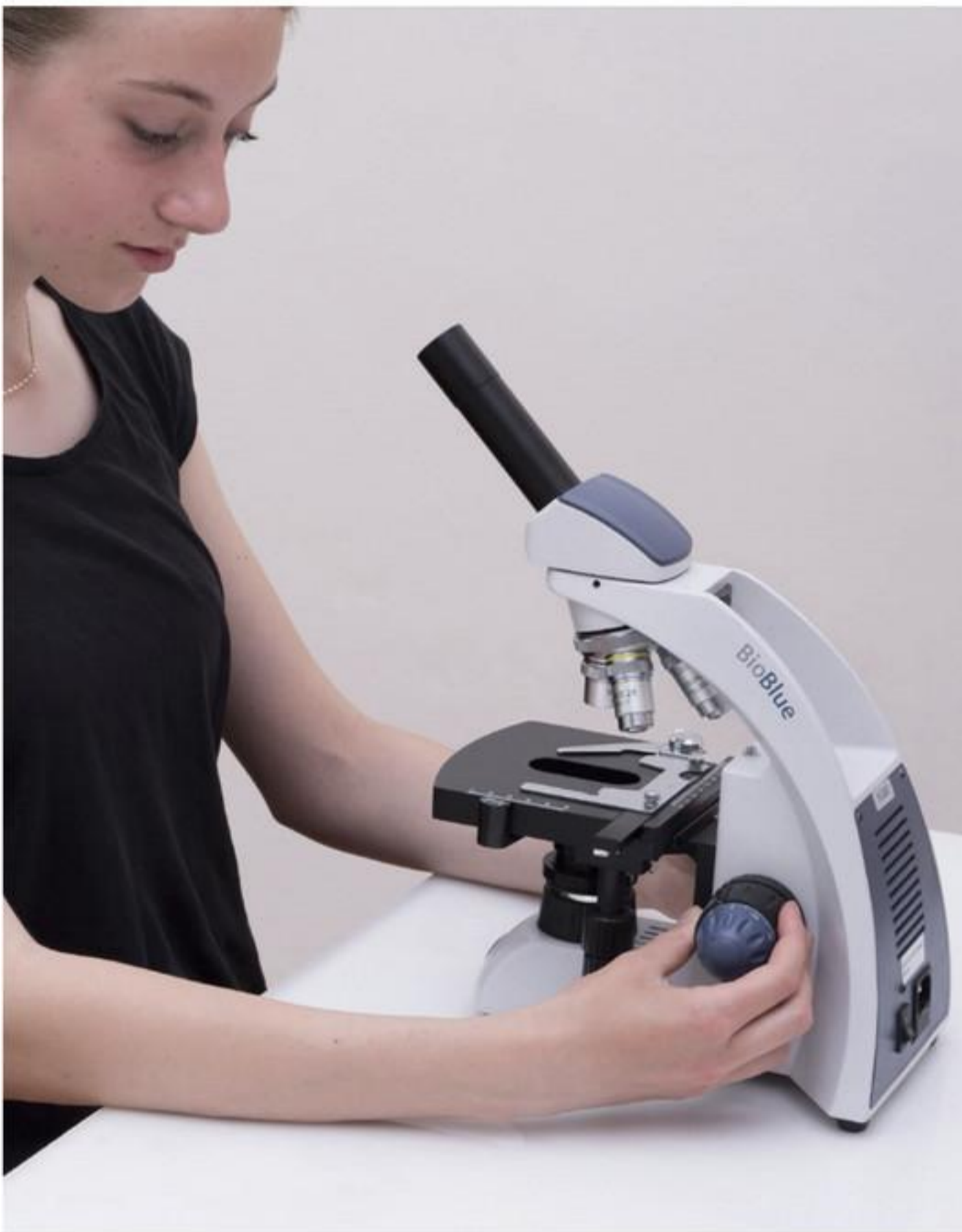
Afb. 6 Scherpstellen bij de kleinste vergroting.
