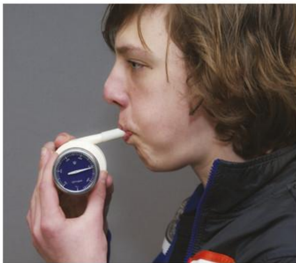
Afb. 7 De vitale capaciteit meten met een spirometer.
