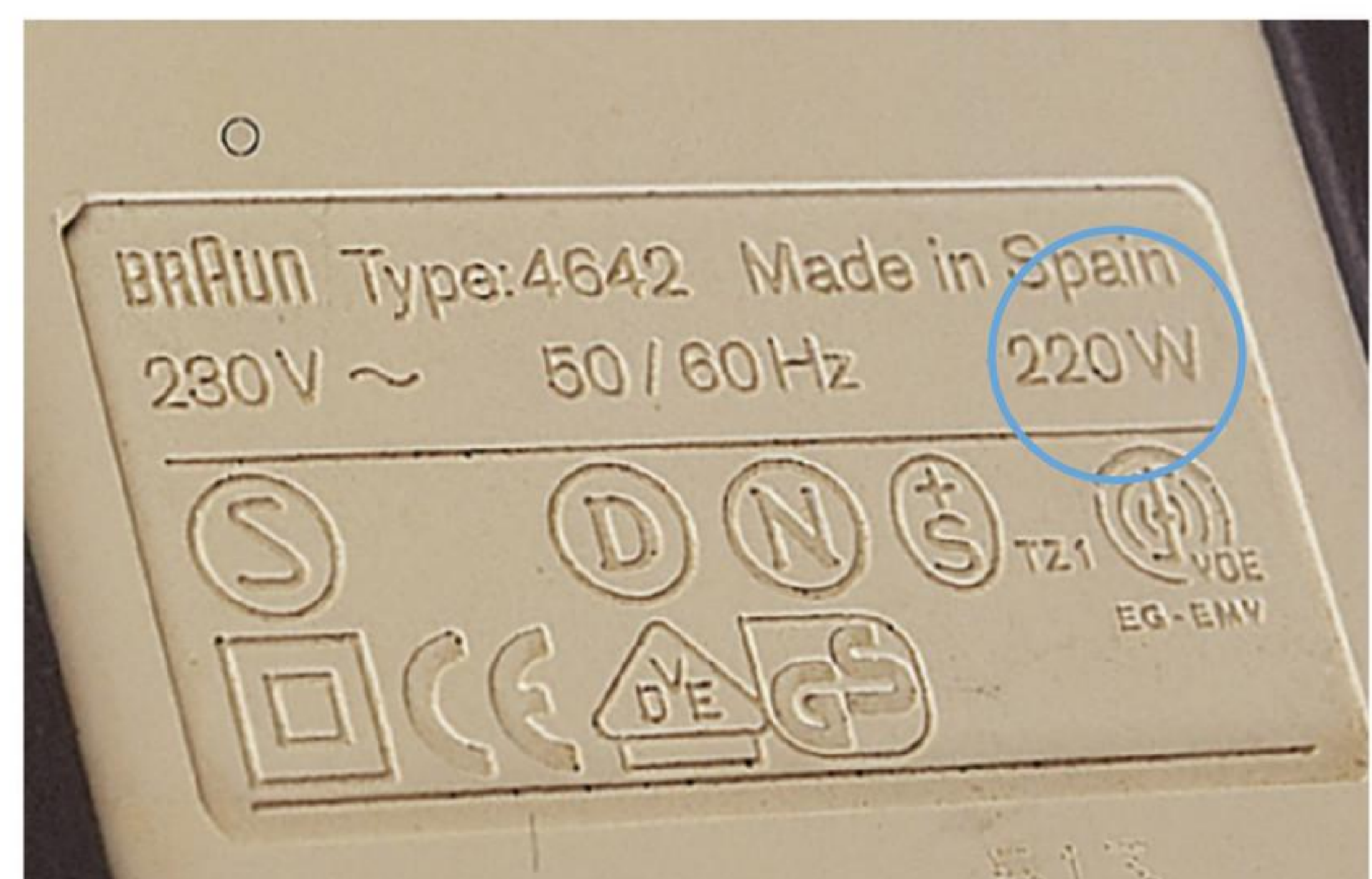
afbeelding 5 Het typeplaatje van een mixer.
