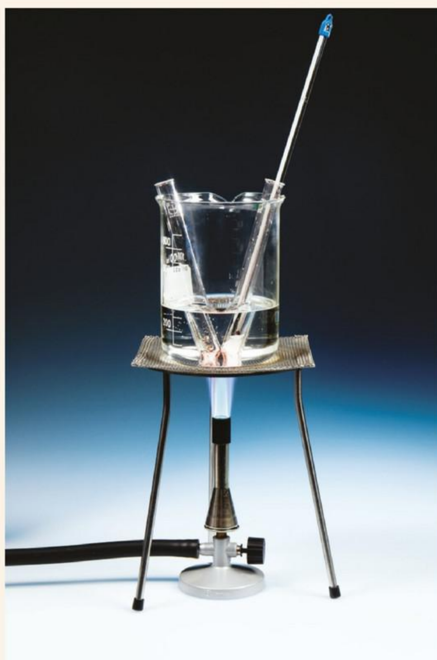
afbeelding 2 Het gebruik van de brander.
