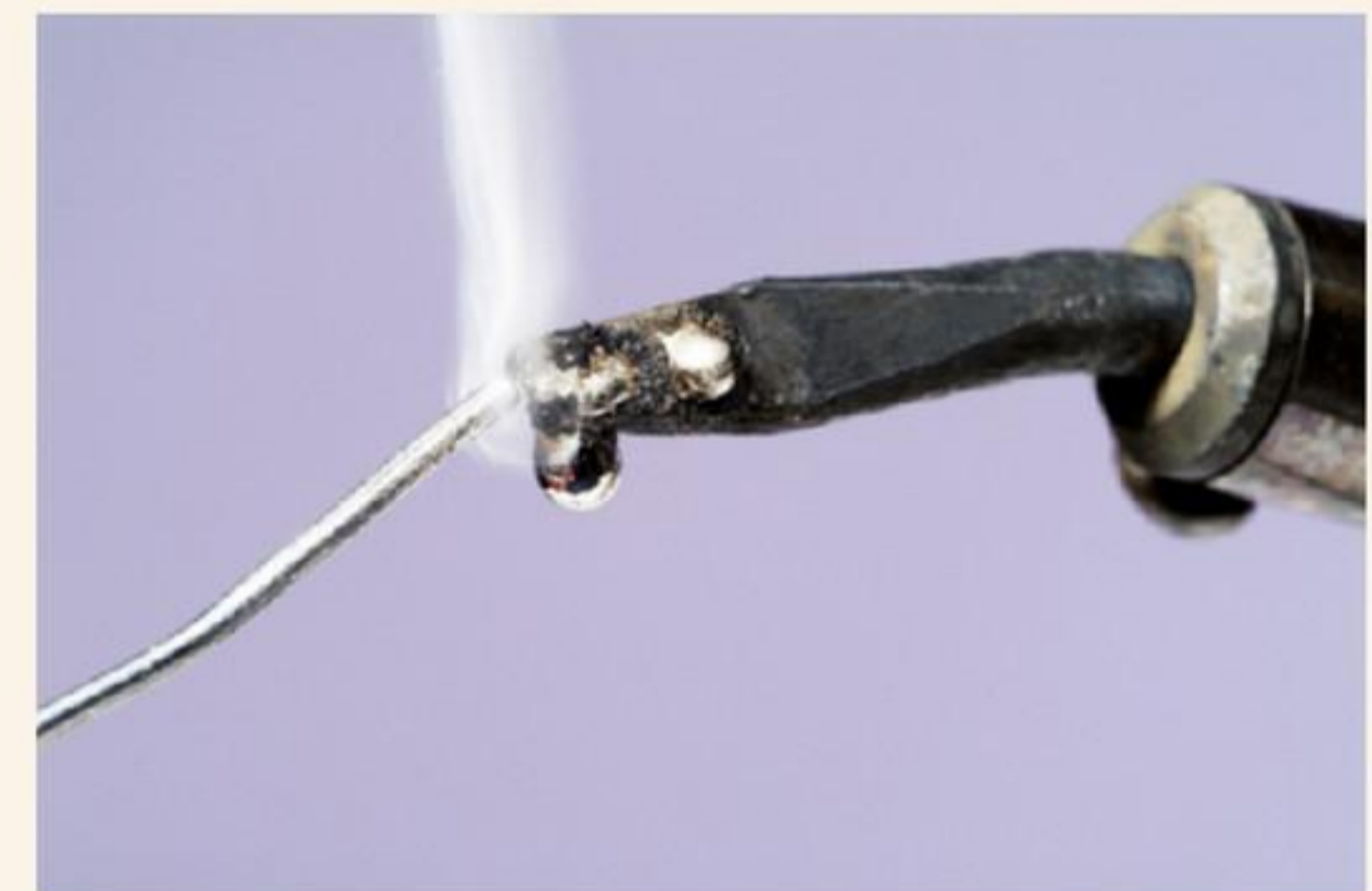
afbeelding 8 Houd het soldeertin tegen de punt van een hete soldeerbout.
