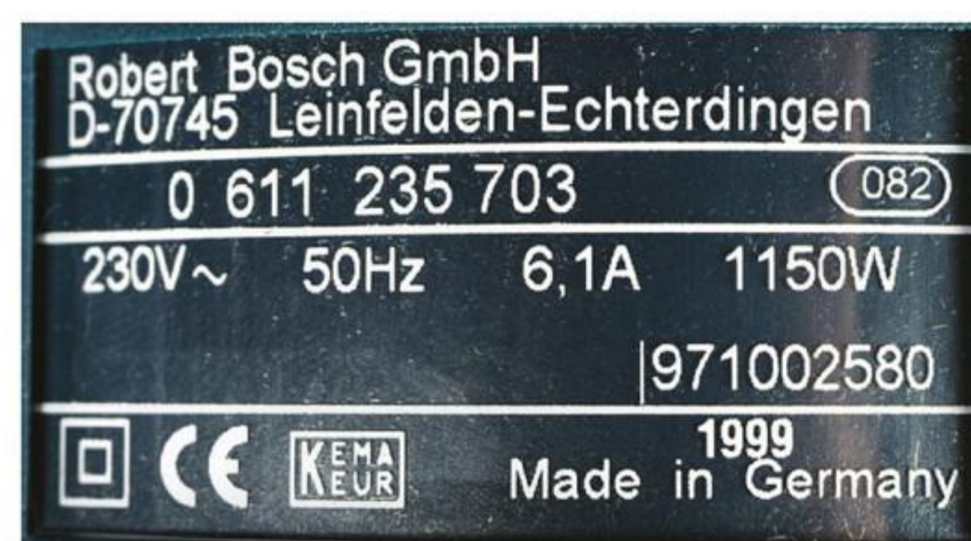
afbeelding 8 Het typeplaatje van een boorhamer.
