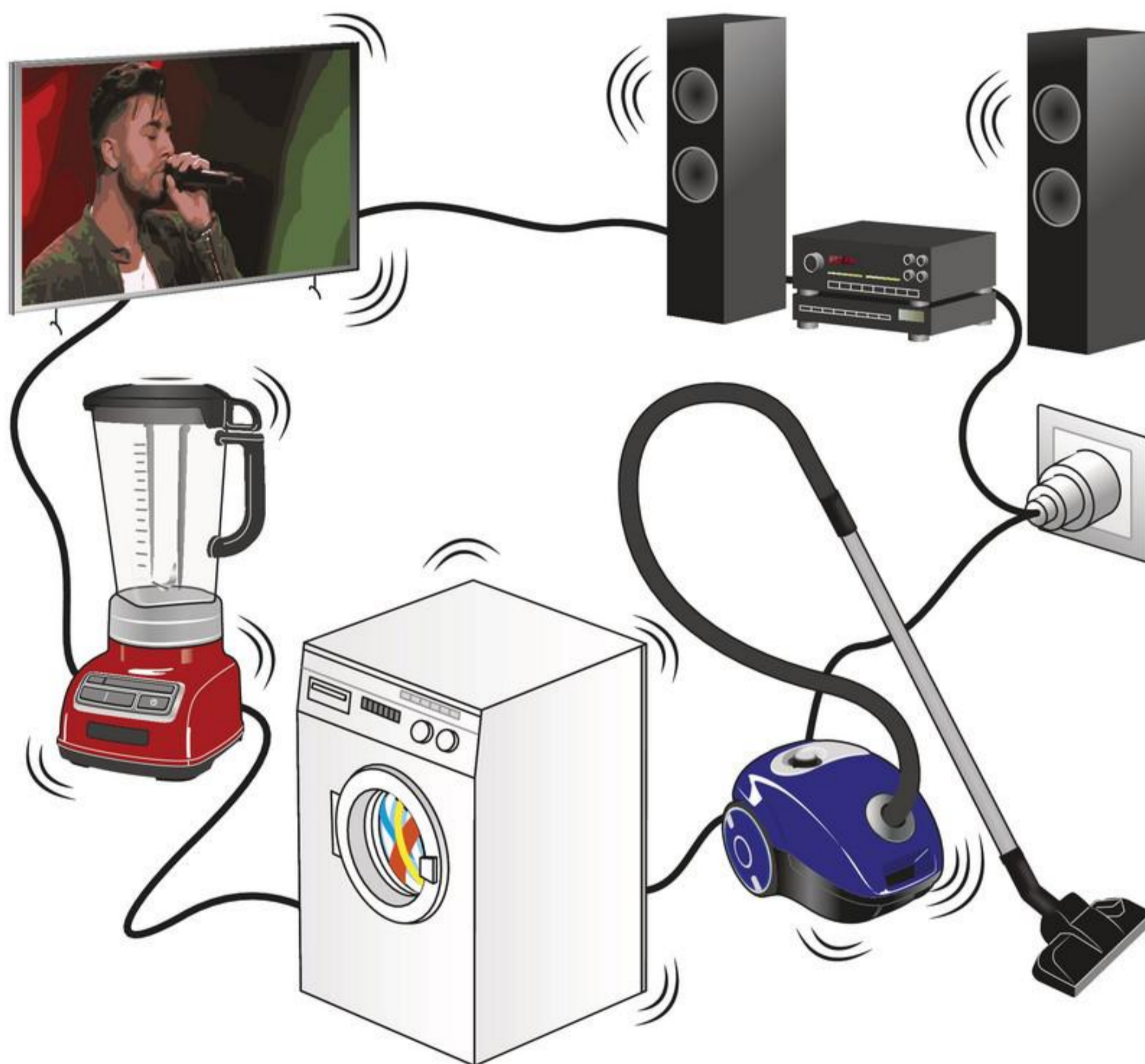
afbeelding 4 Alle apparaten zijn hier in serie geschakeld.
