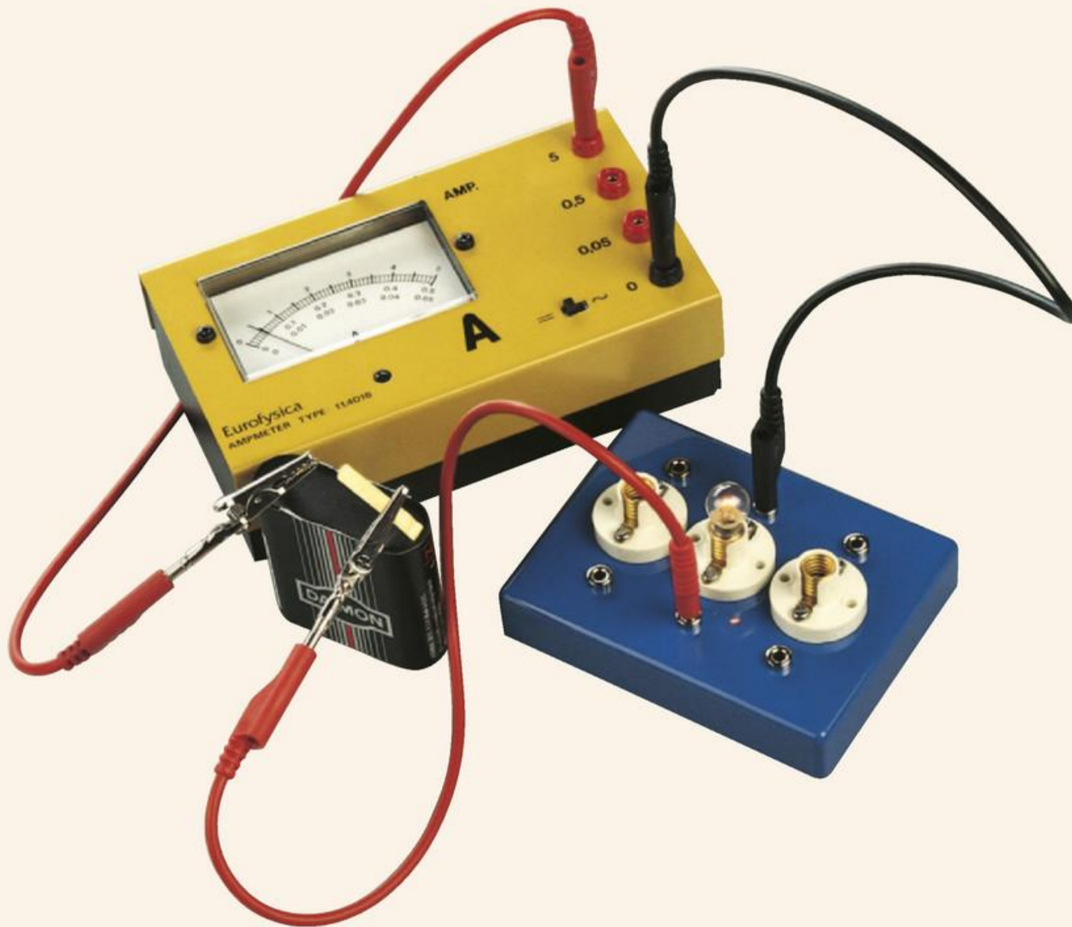
afbeelding 4 Een ampèremeter sluit je altijd in serie aan.
