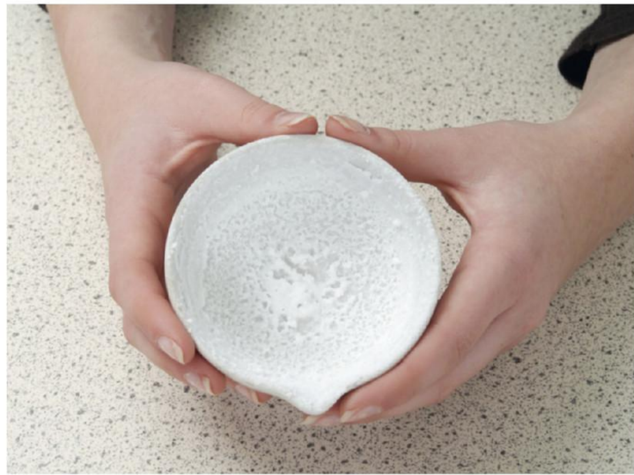
afbeelding 4 Het water is verdampt en het zout blijft over.
