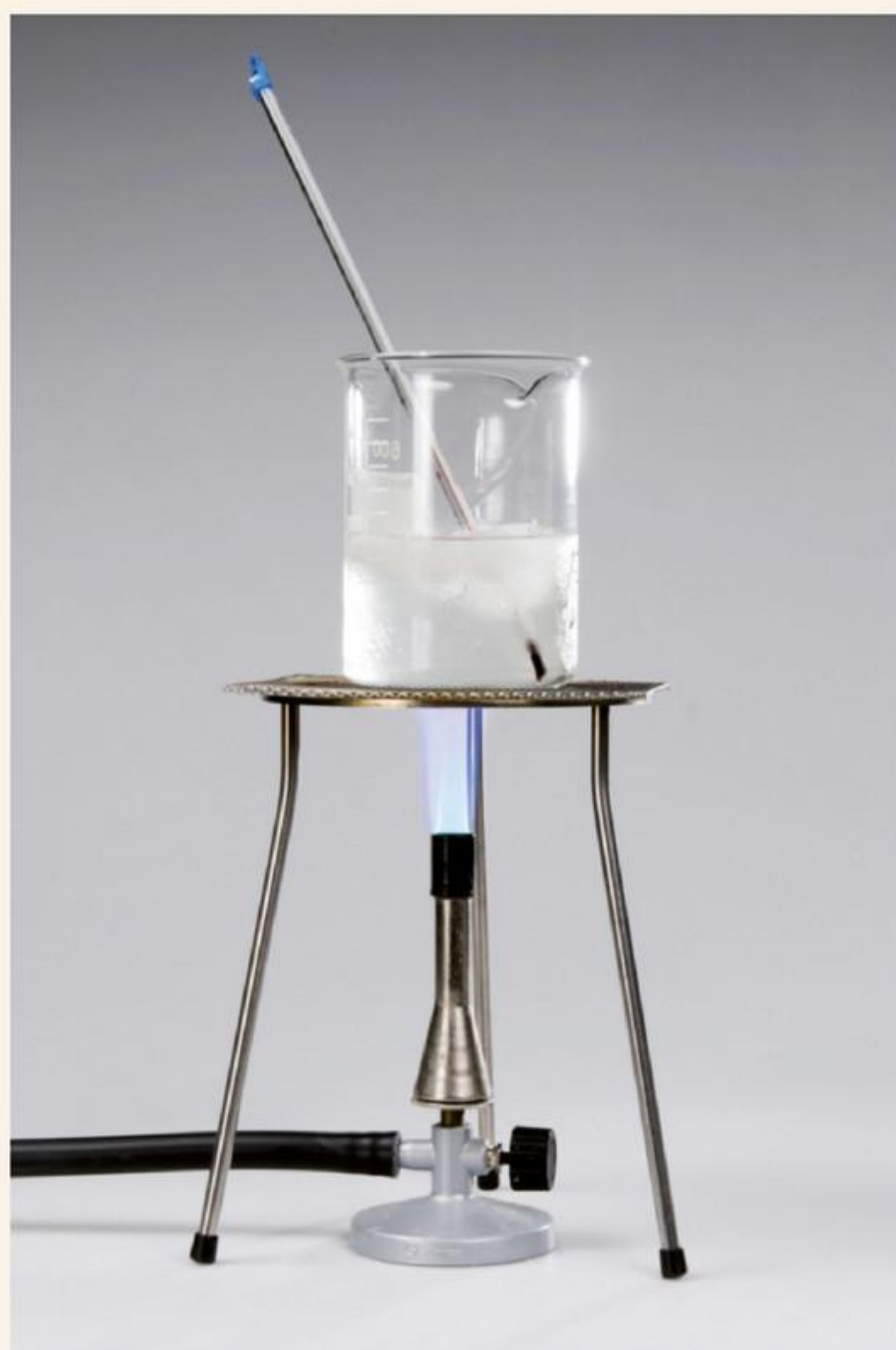
afbeelding 5 Het bekeerglas op een gaasje op de driepoot.
