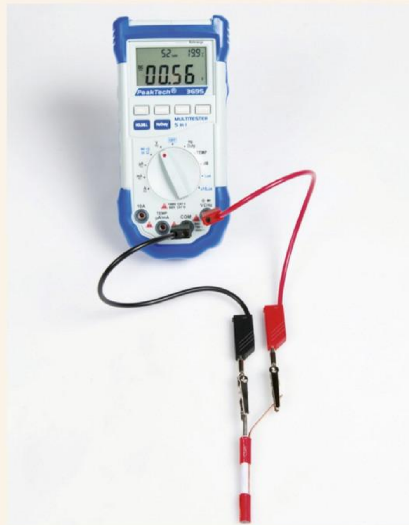
afbeelding 19 De batterij aangesloten op de voltmeter.
