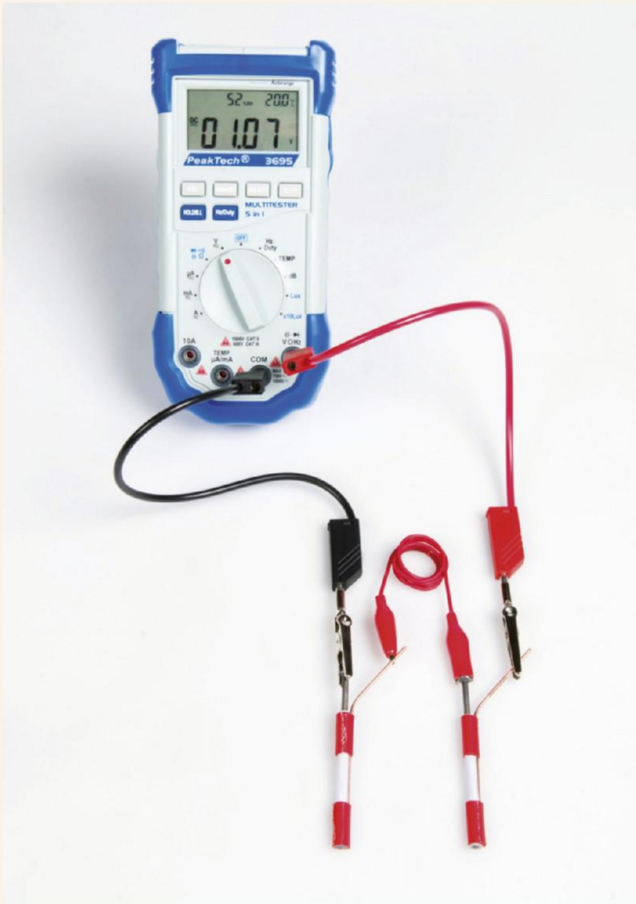
afbeelding 20 Twee batterijen aangesloten op de voltmeter.
