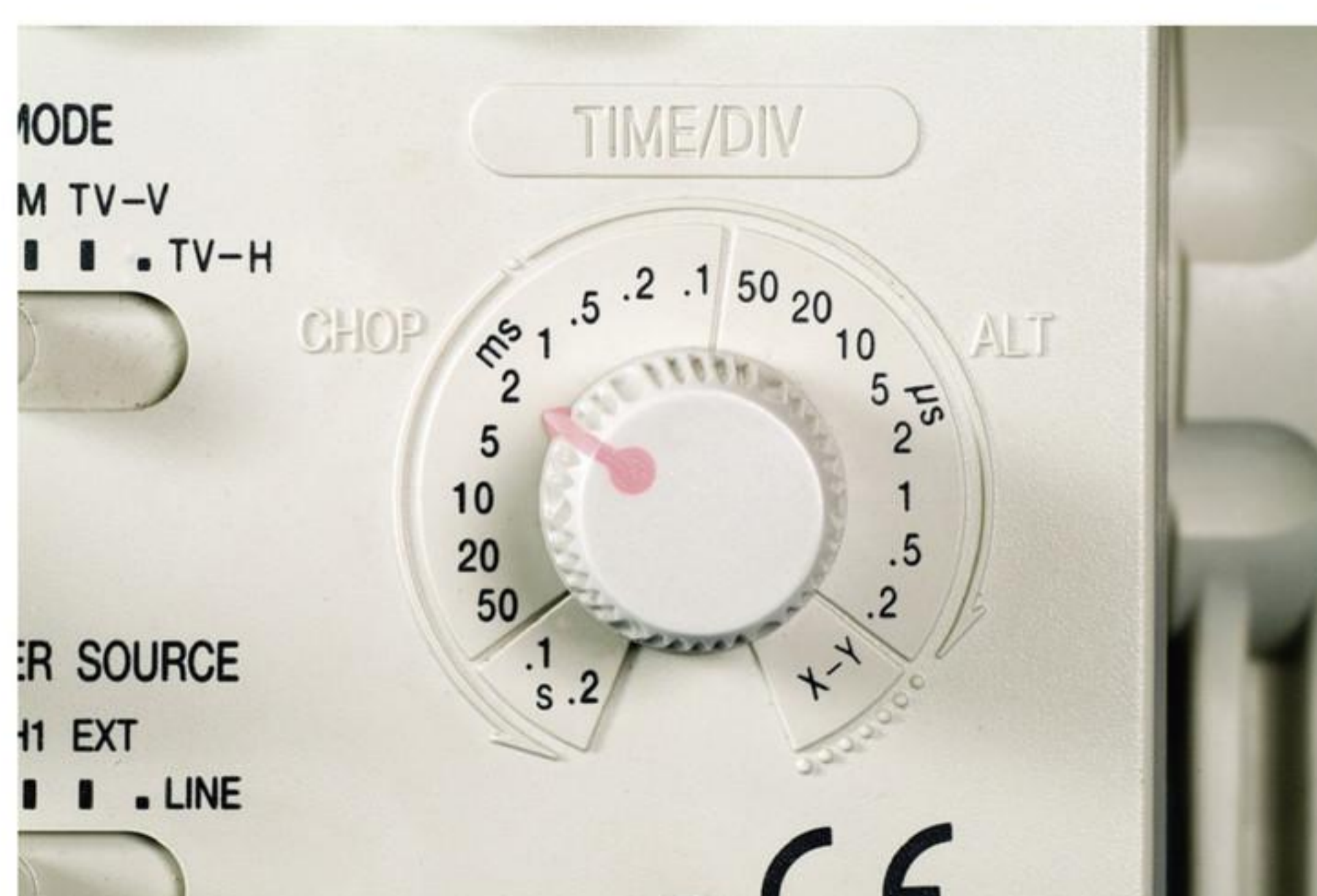
figuur 12 De tijdbasis van een oscilloscoop.
