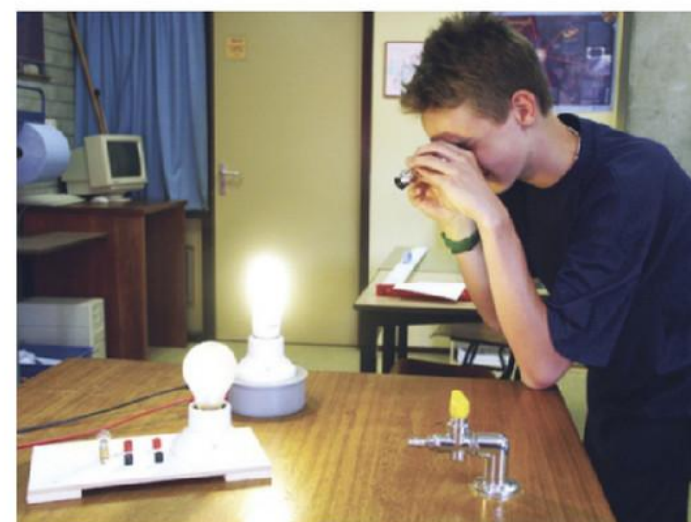
figuur 2 Zo gebruik je een zakspectroscop.
