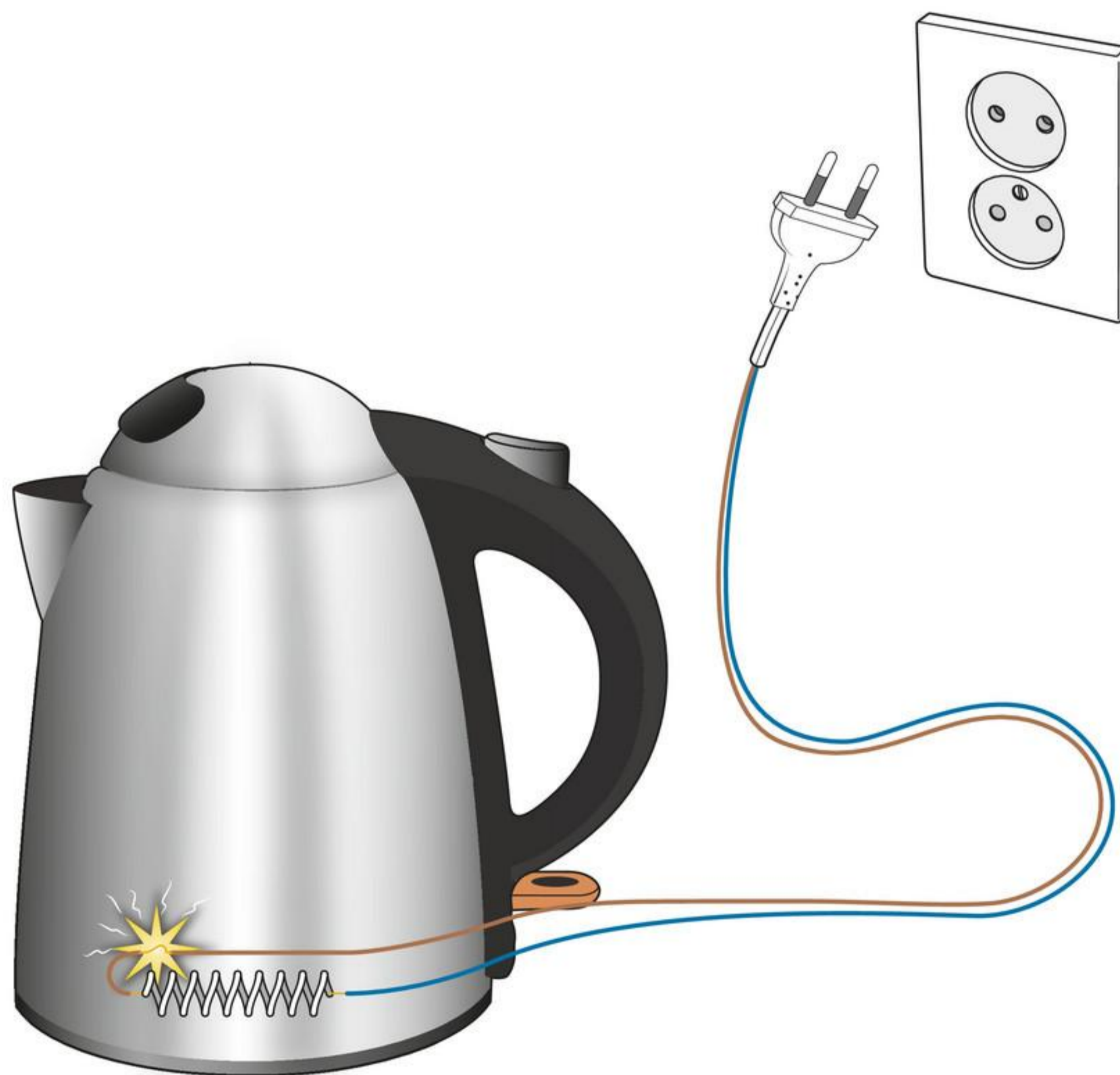
afbeelding 2 Door een kapotte draad kan de buitenkant onder spanning staan.
