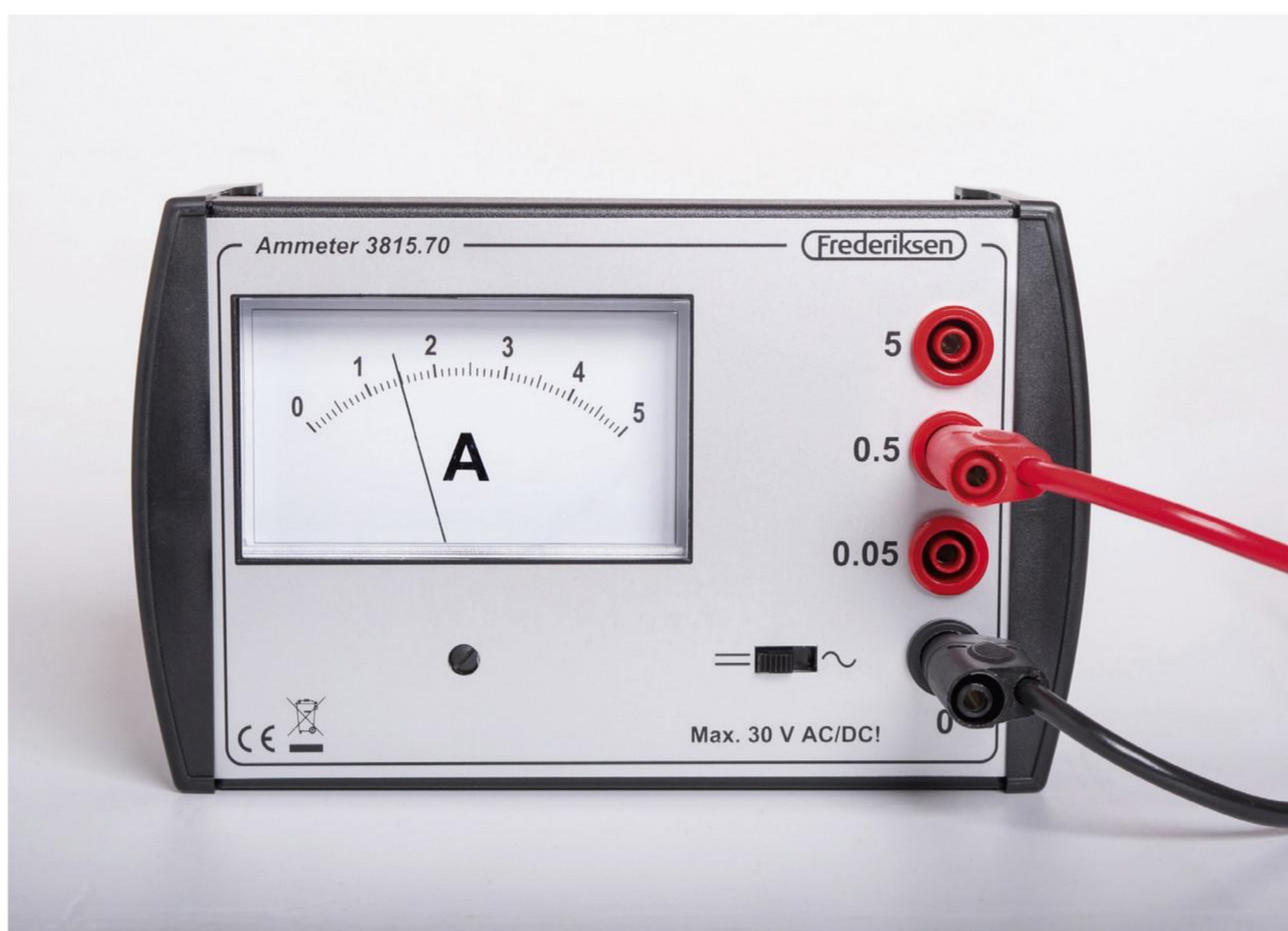
afbeelding 6 Meter die de lekstroom aanwijst.
