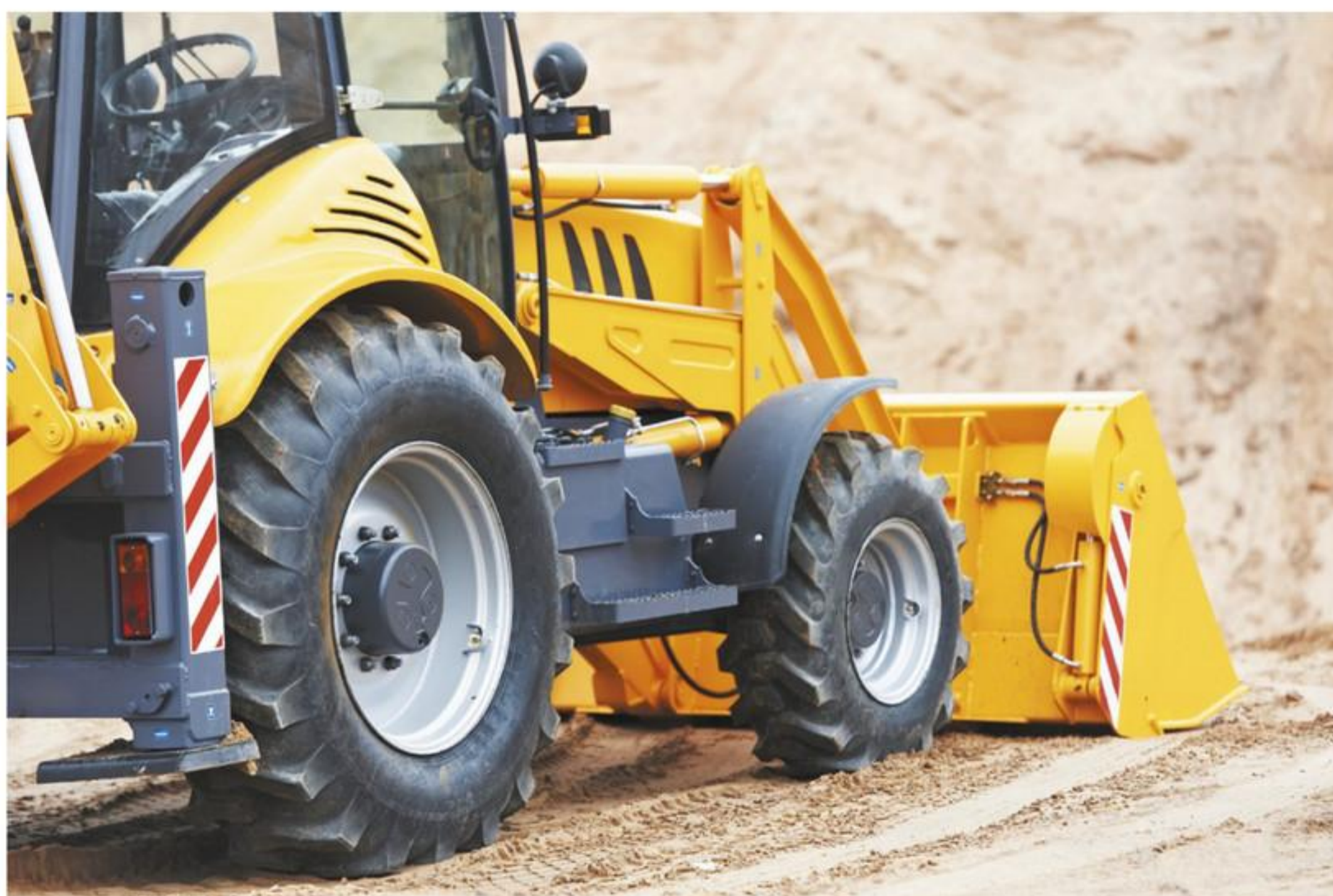
afbeelding 1 Tractorbanden verdelen het gewicht.
