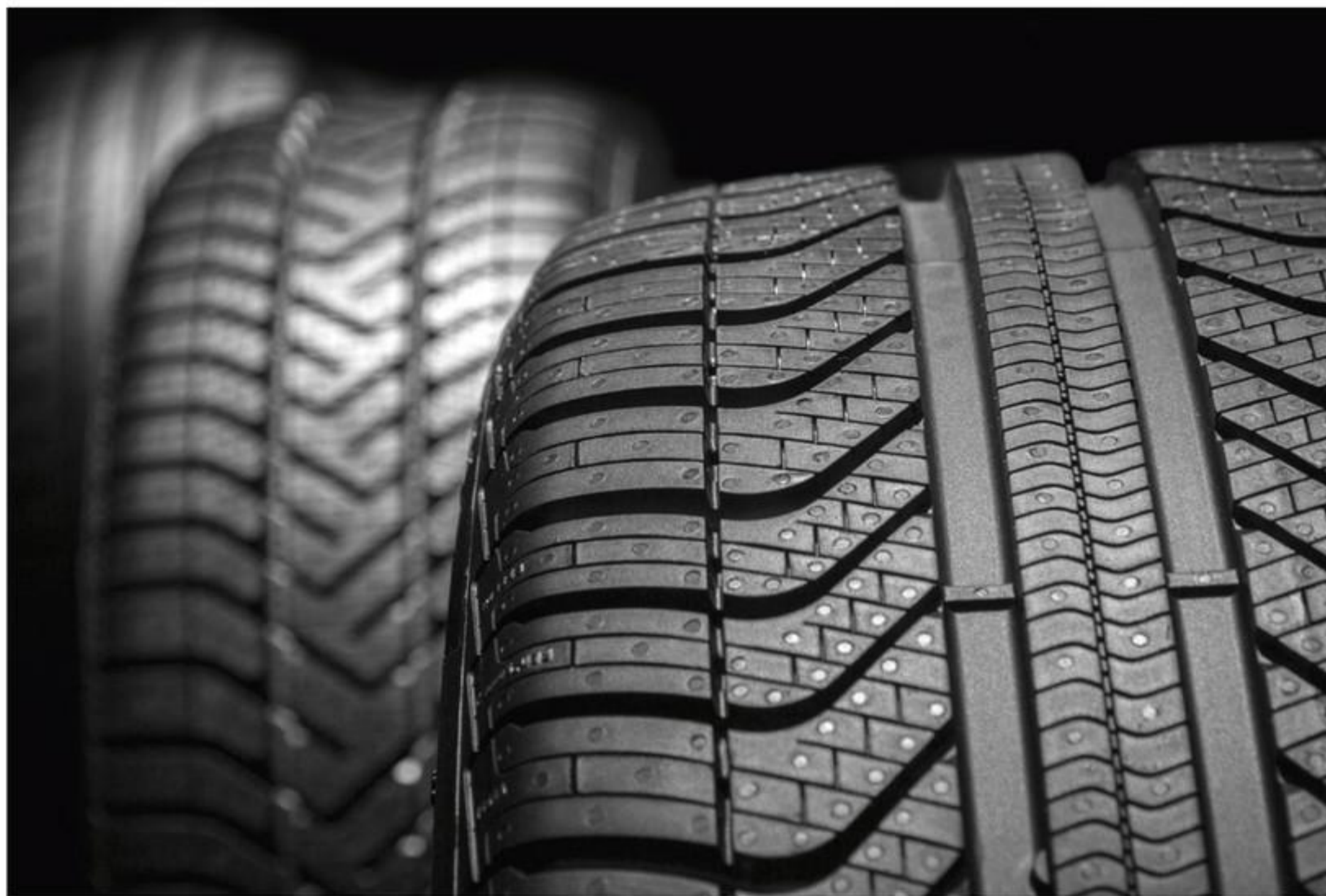
afbeelding 6 Een goede band heeft een diep profiel.
