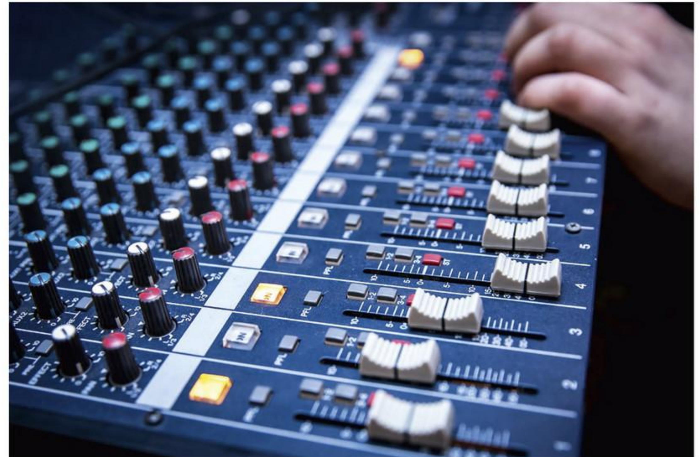
afbeelding 11 Een mengpaneel met ronde en rechte schuifweerstand.
