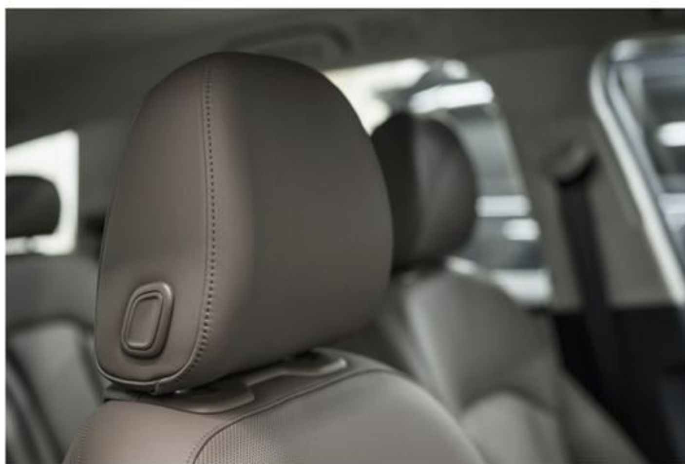
afbeelding 7 De hoofdsteun voorkomt beschadiging van de nek.
