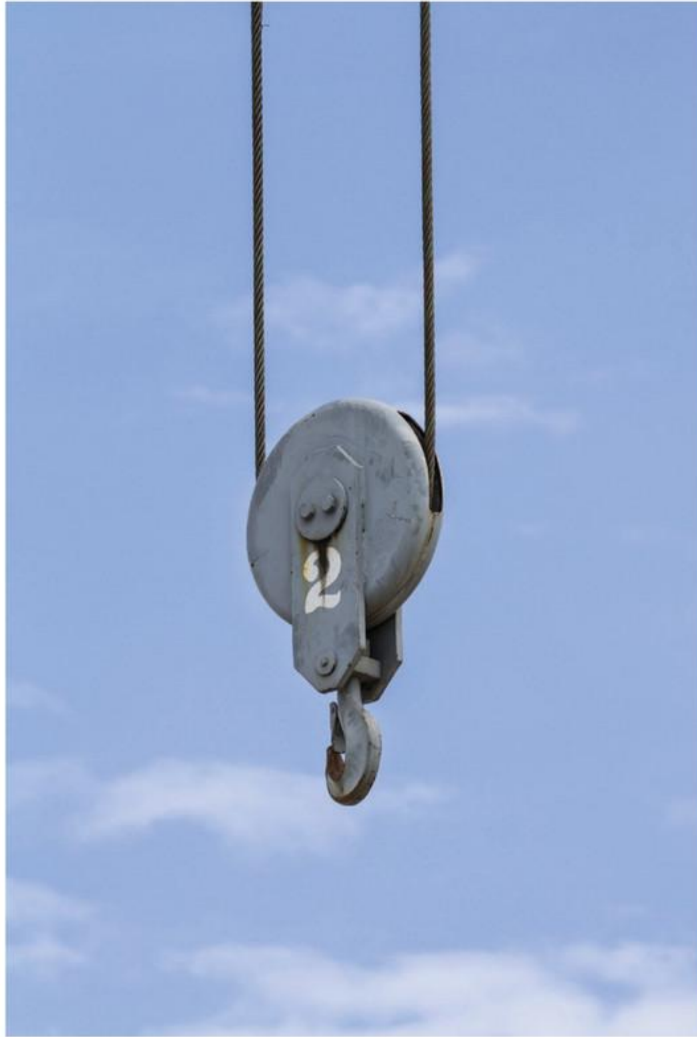
afbeelding 3 Een losse katrol hangt aan het touw.
