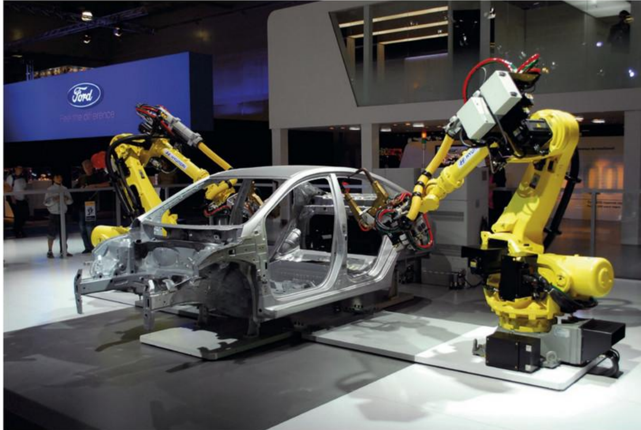
afbeelding 3 De auto is gebouwd rond een kooiconstructie.
