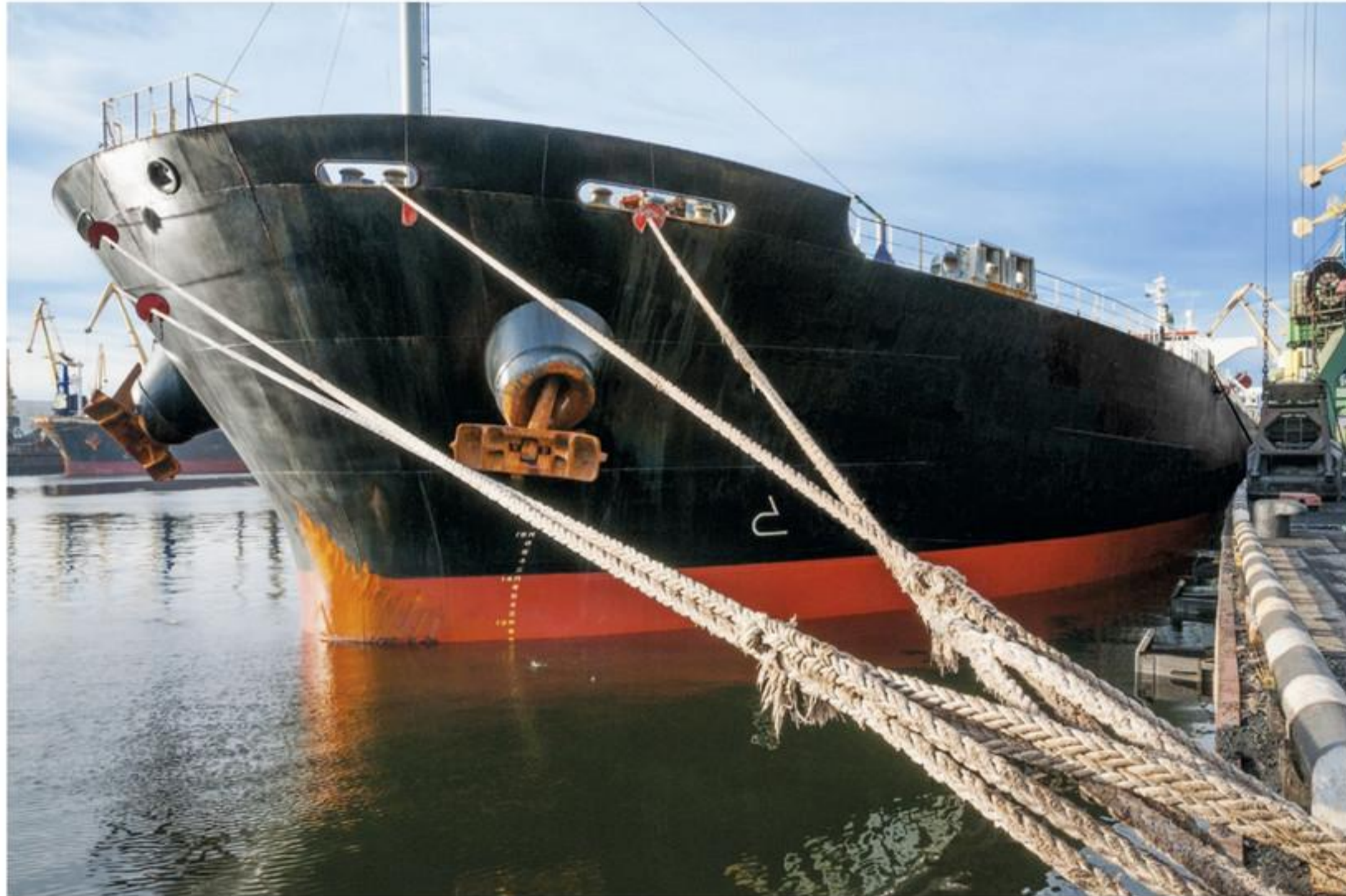
afbeelding 4 De spankrachten in de touwen houden het schip op zijn plaats.
