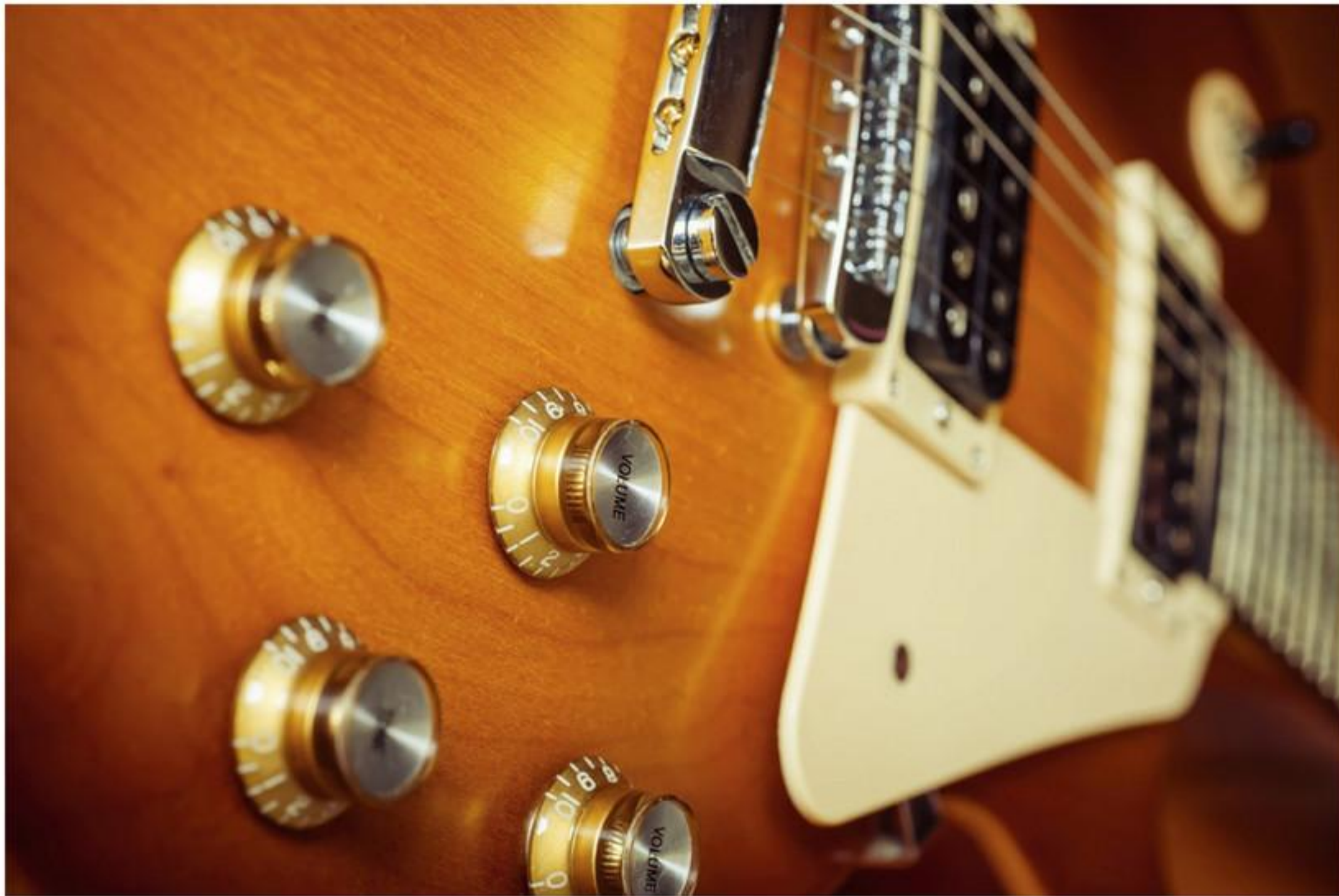
afbeelding 10 Vier ronde schuifweerstand op een elektrische gitaar.
