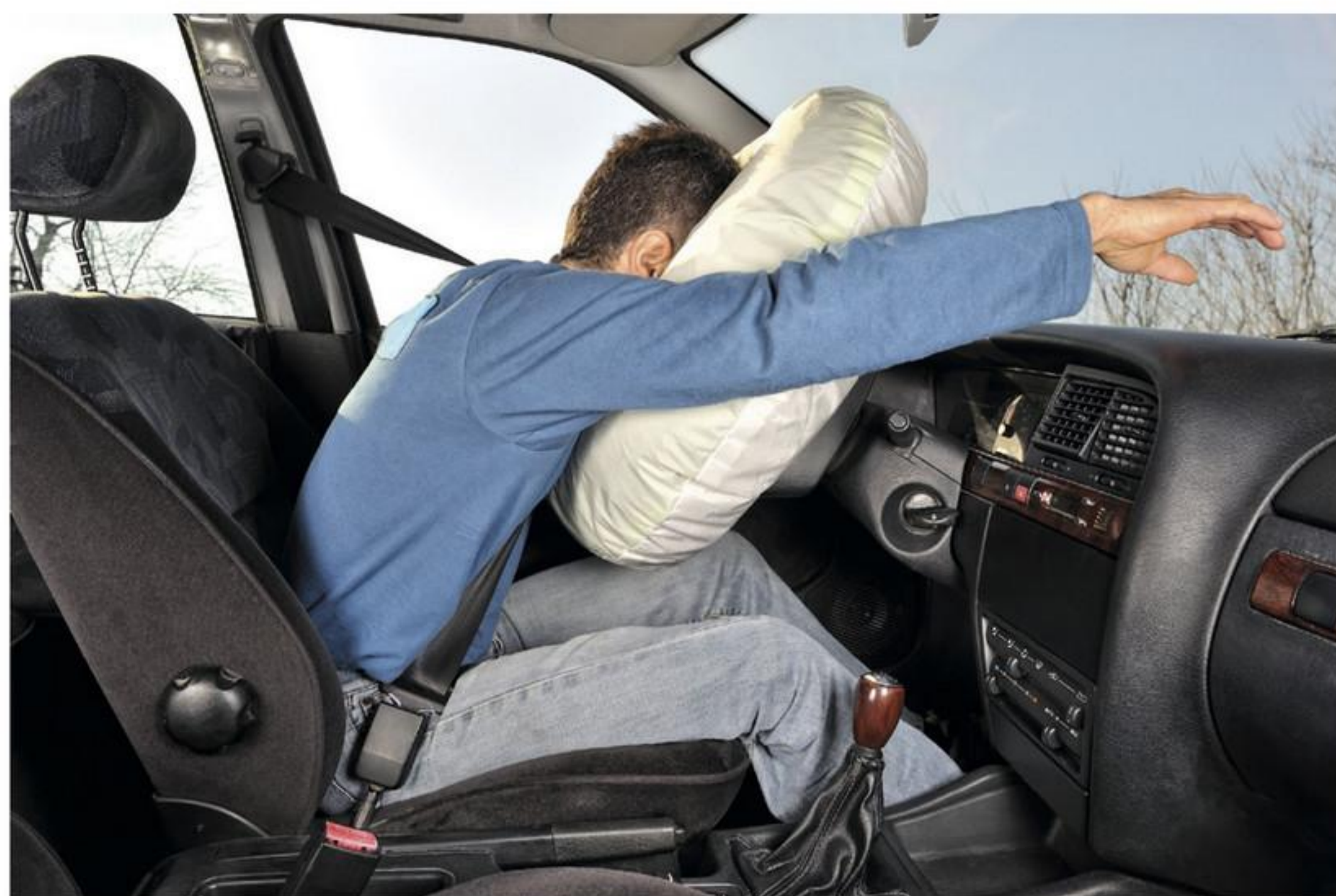
afbeelding 8 Een airbag vangt het hoofd op bij een botsing.
